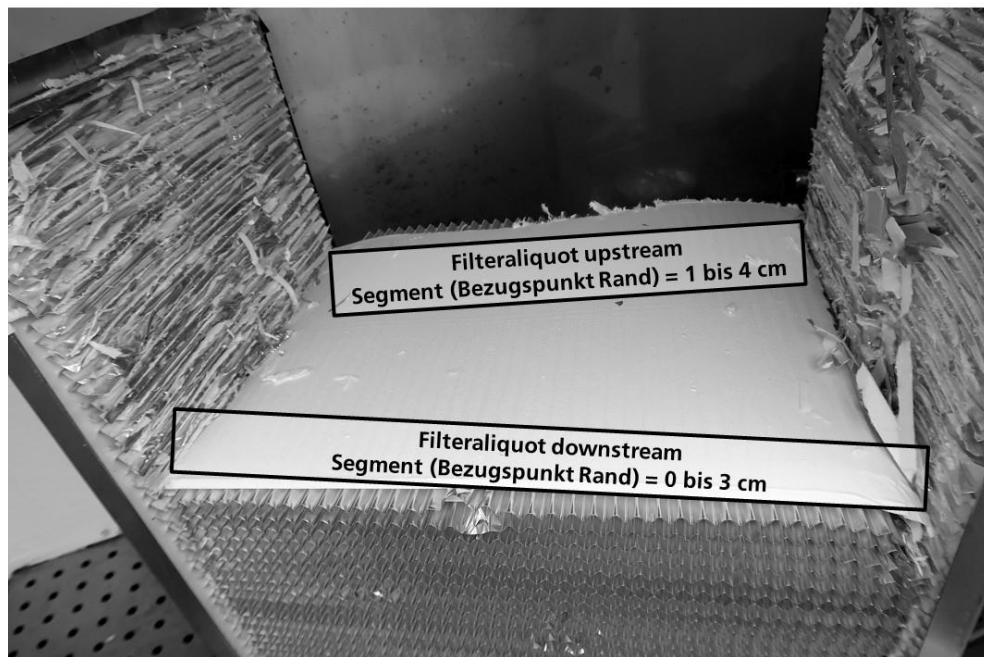
Bild 4: Aufsicht auf das Filtervlies im mittleren Bereich der Kassette. Die Markierungen zeigen schematisch die Probenahmepositionen für die Probenahme 2 (P2; downstream) und 3 (P3; upstream).
