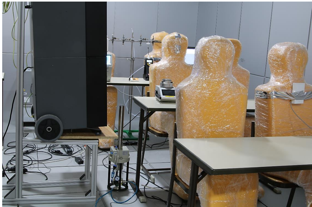
Bild 1: Aufbau TAC V+ -Luftreinigungsgerät im IATC mit Aerosolgenerator (Dosiergerät), Sensortechnik und Luftkeimsammler.
